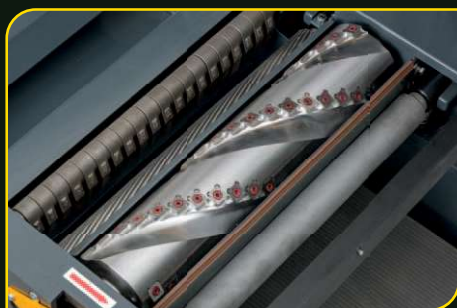
Spirálový válec s podávacími válci
