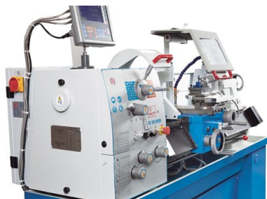
Potřebné otáčky vřetena Basic 180 Super se volí pomocí 16stupňového hlavního pohonu
