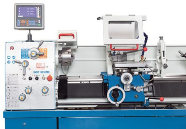
Potřebné otáčky vřetena Basic 180 Super se volí pomocí 16stupňového hlavního pohonu
